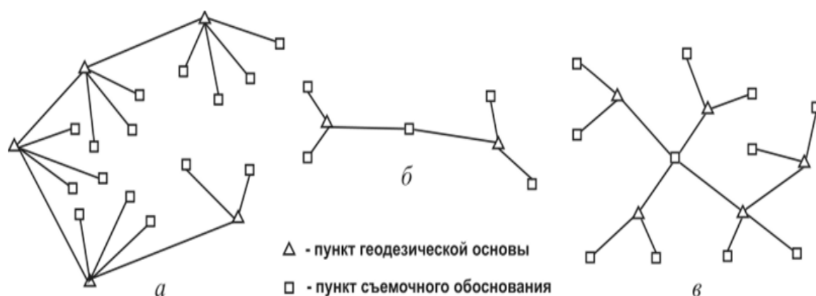
Рис. 2. Схемы построения съёмочного обоснования лучевым методом
